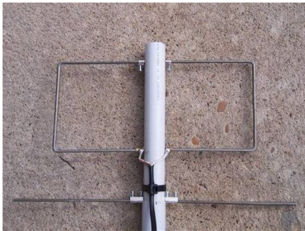
Foto 4: Detalle de fijación de los elementos al boom y conexión del coaxial al elemento radiante
