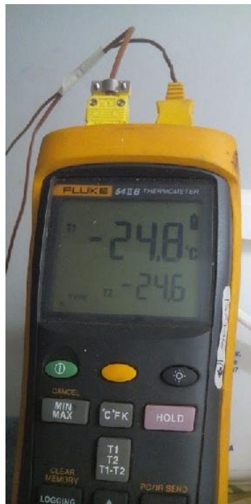
Probando y calibrando diferentes sensores de temperatura
